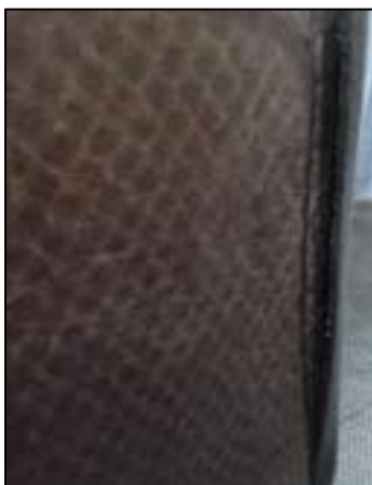
Figura 2. Defecto de delaminación presentado en un producto terminado.
