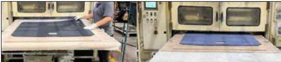
Figura 4. Estación de trabajo semiautomática para la aplicación de adhesivo en tela.
