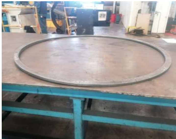
Figura 7. Prueba de nivelación verificación visual.
