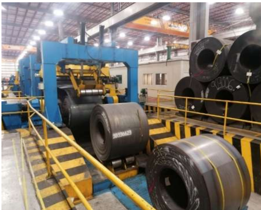
Figura 4.- Instalación de rollos en proceso de nivelado.
