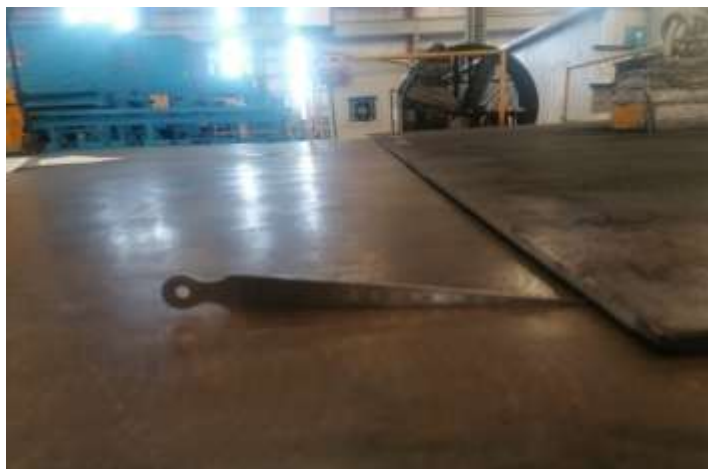
Figura 8. Calidad de nivelación. Medición de nivelación en milímetros.
